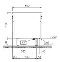
Electrical inlet (power) Equipotential screw
